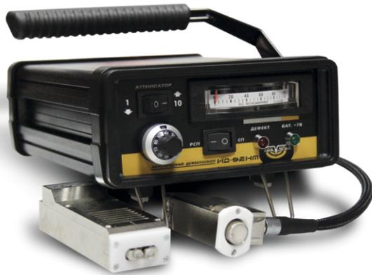
Акустический дефектоскоп ИД-92НМ предназначен для акустического контроля изделий из композитных и других материалов с большим затуханием с помощью импедансного метода и метода свободных колебаний, на предмет определения расслоений, непрочиев, внутренних дефектов в изделиях из слоистых пластиков, композитных и сотовых материалов. Внесен в Госреестр СИ.
